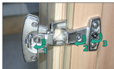
Auflage verstellen: Schraube 1 Höhe verstellen: Schraube 3 (Schraube 2 leicht aufdrehen)
